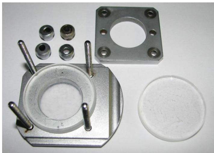
Obr. 12. Rozebíratelná KBr kyveta pro transmisní měření
