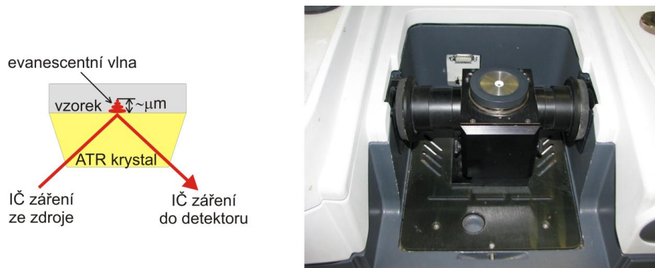
Obr. 7. (a) Průnik evanescentní vlny do vzorku, (b) reálný pohled na ATR krystal
