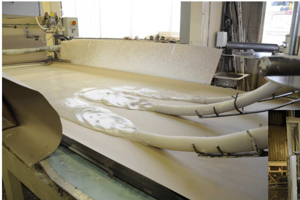
Výroba sádrokartonu – lití suspenze
