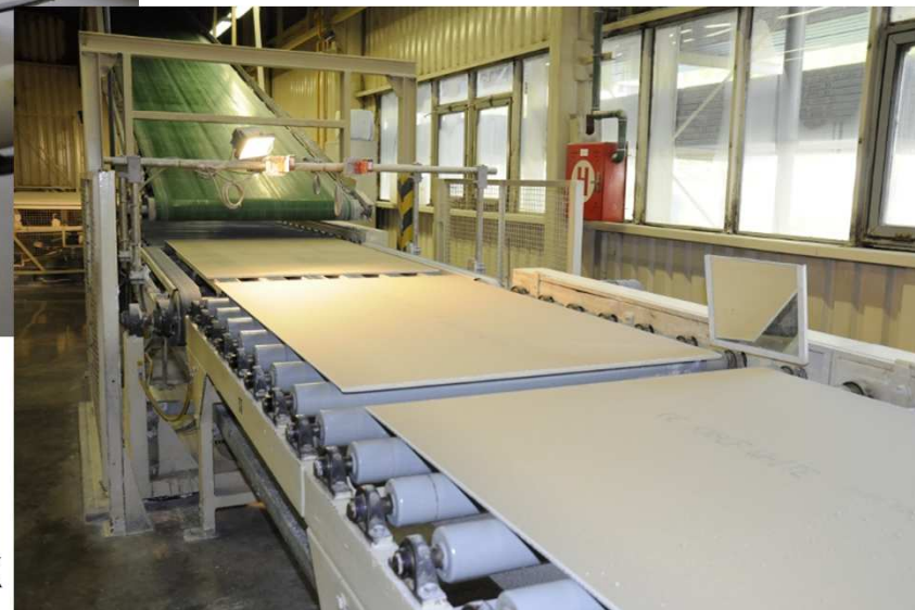
Výroba sádrokartonu – lití suspenze
