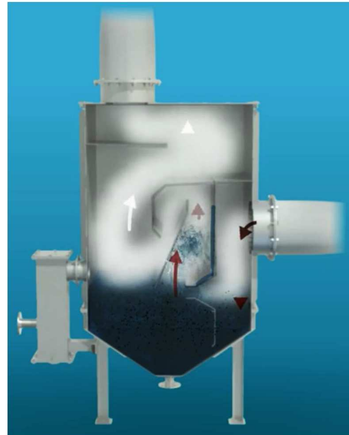
Odlučovač s tečným vstupem (vpravo ACO Ltd. Wet Scrubber)
