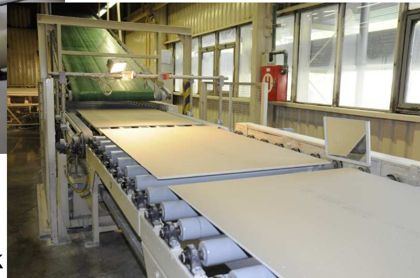
Výroba sádrokartonu – lití suspenze
