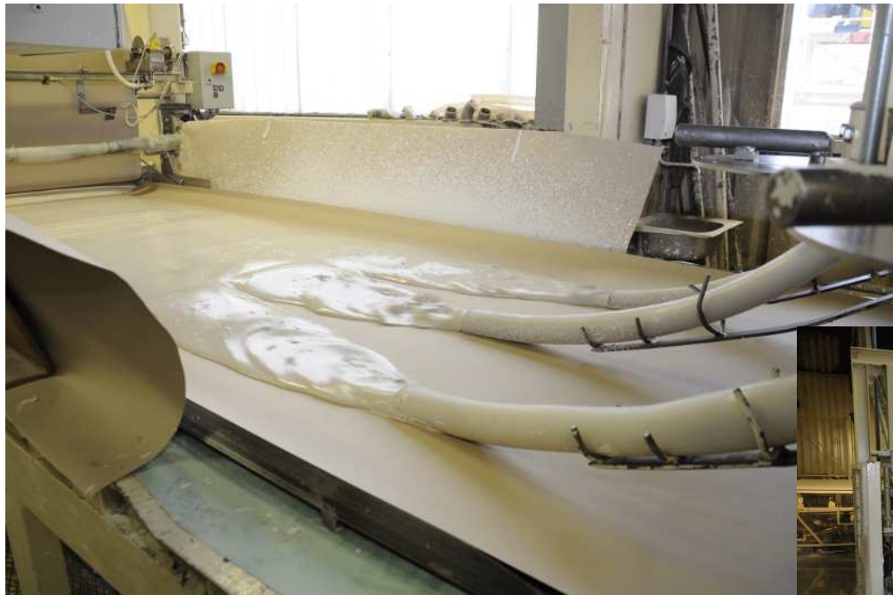
Výroba sádrokartonu – lití suspenze
