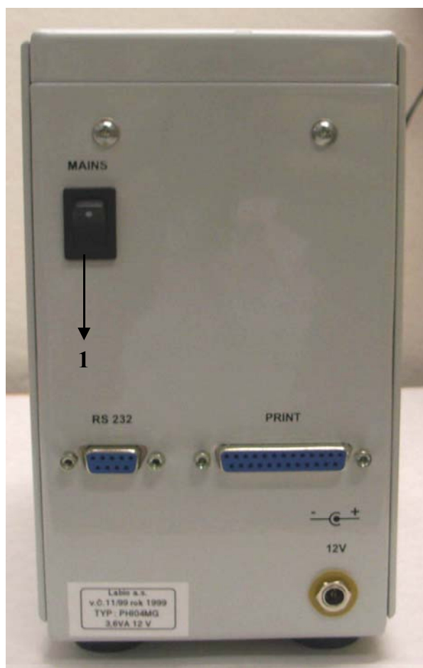
Obr. 2. Čelní a zadní panel pH metru PHI 04
