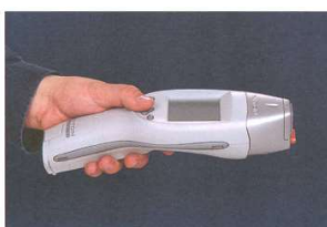
přenosný spektrometr s radioizotopovým zdrojem záření a polovodičovým detektorem
