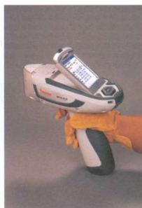
přenosný spektrometr s malou rentgenkou a polovodičovým detektorem hmotnost 1,4 kg
